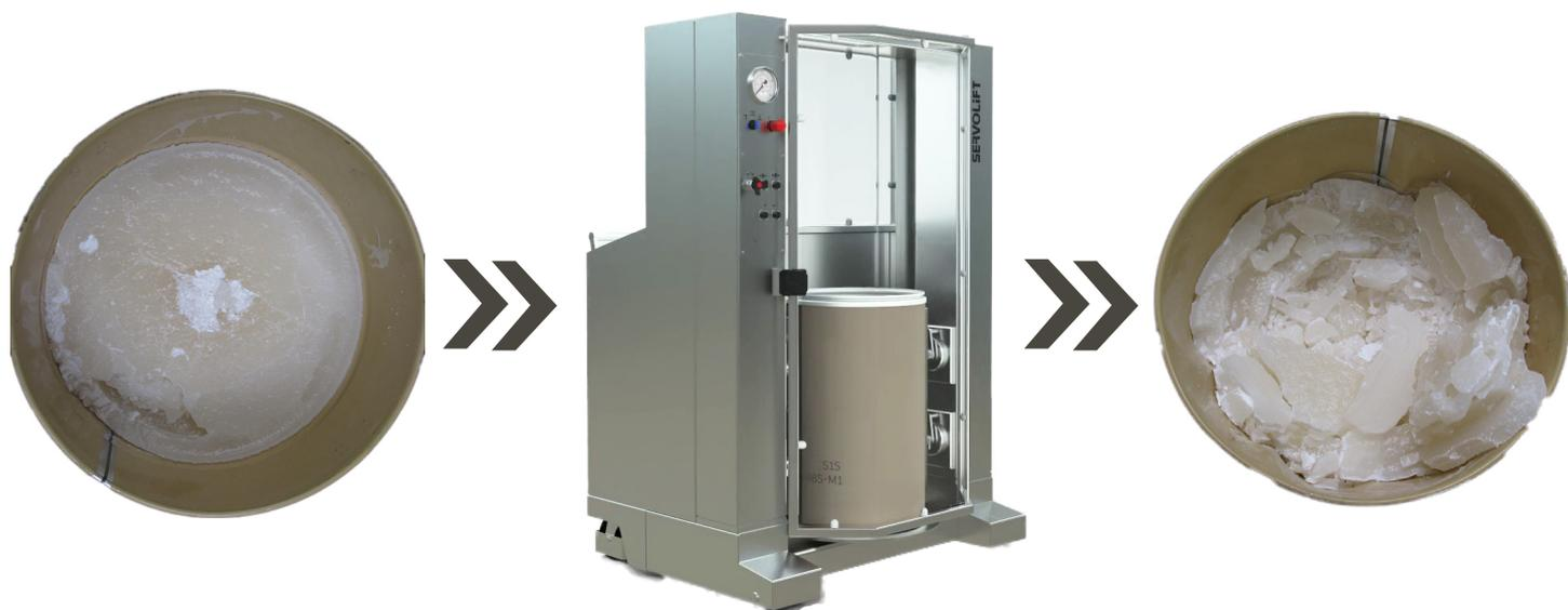
Le plateau rotatif permet de positionner le fût par rapport aux mâchoires de blocage de manière optimale. Les 4 vérins, actionnés par paire, permettent d'appliquer les forces aux endroits désirés. L'écraseur de fûts peut être installé à demeure ou sur chariot mobile non motorisé. La porte et la protection supérieure en plexiglas permettent un travail propre, en toute sécurité, tout en surveillant le déroulement du process.
